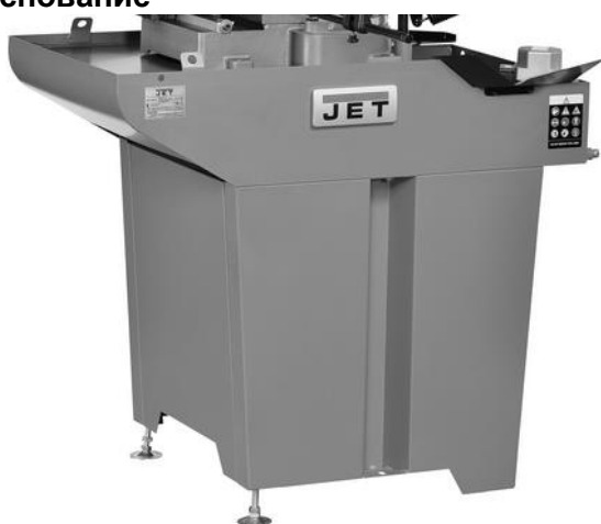
Рисунок 8 Основание поддерживает пыльную раму, тиски, концевой упор, суппорт заготовки, охлаждающий насос, поворотную руку и сливные пластины охладителя. В корпусе основания расположена емкость для охлаждающей жидкости.
