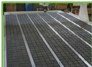
Вакуумный рабочий стол с «Т» - пазами для механического крепления
