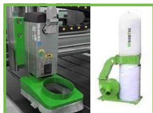
Аспирационный кожух и пылеулавливающий агрегат
